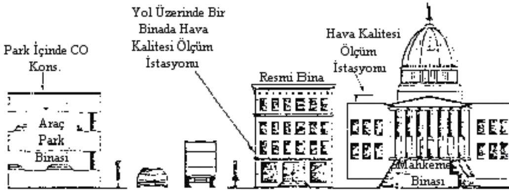
Şekil 4. Şehir İçinde Karbon Monoksit Konsantrasyonunu Ölçmek İçin Numune Alma Yeri Tespiti
